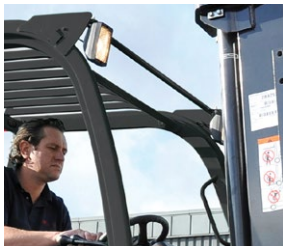
Éclairages LED avant
